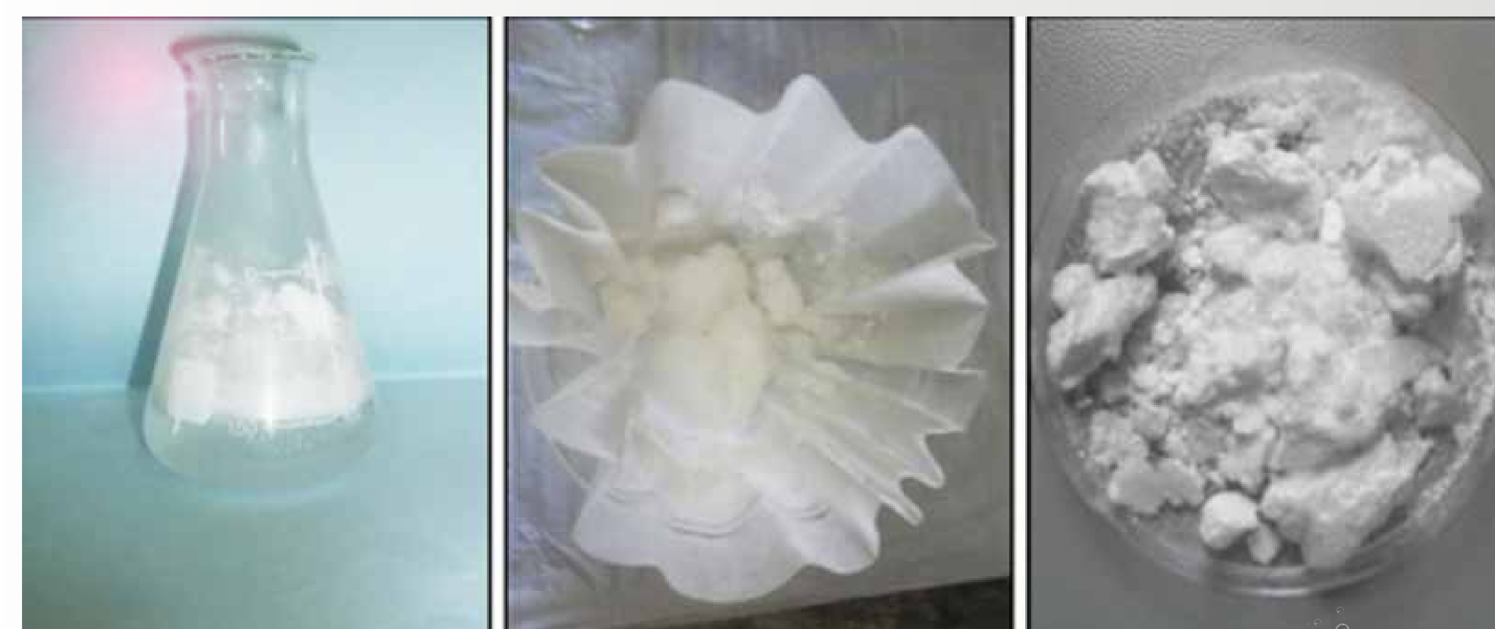
Figure 2 : Précipitation, filtration et séchage des cristaux d'acide benzoïque
