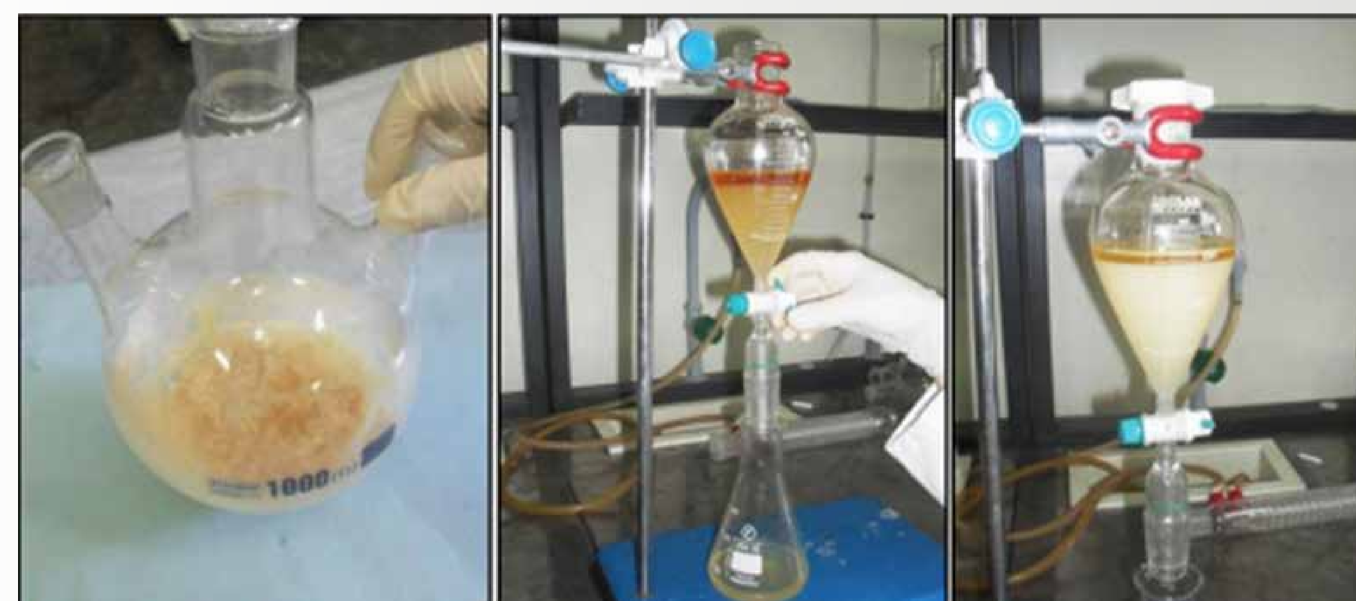
Figure 1 : Refroidissement et décantation
