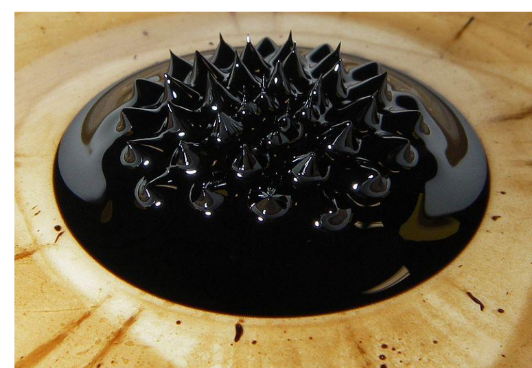
Ferrofluide se hérissant en pointes dans le champ magnétique d'un aimant
